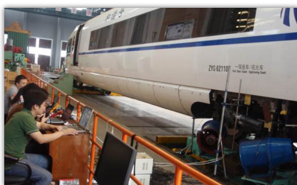
高速列車採用智能阻尼器的足尺振動控制試驗
