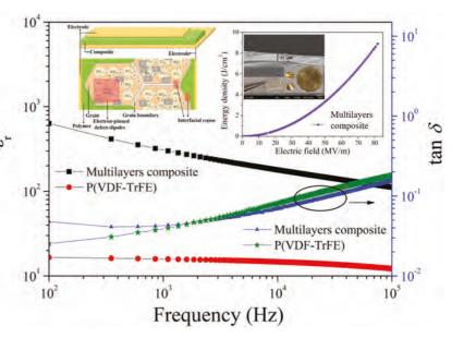
全球對能源儲存的需求在過去十年急劇飆升,不少科研團隊因而 相繼投入創新電容器的研究,力求研發出比傳統電池充電更快、 儲存功率更高、循環壽命更長的電容器。理大此項發明乃首次在 含有金屬離子摻雜巨介電材料的柔性複合電容器中,實現同時具 有高儲存能量値、極小能量漏失率和高能量儲存密度。此技術主 要採用二氧化鈦,是無毒、環保的材料,而且蘊含量豐富和製造 成本低,相比傳統的化學電池結構,具多方面優勢,包括提高安 全性。
