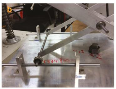
在微重力的環境下,例如身處太空船上,長期的微振動會有機會損壞艙內的儀器。微振動是指由機械系統所產生的低幅度振動。理大研究團隊研發了一個能大幅減低由機械系統所產生的振動的仿生物非線性抗振系統,相對現有技術,其性能更可靠,成本更具效益。團隊參照雀鳥昆蟲肢體結構的抗振功能,尤其是每天啄木數百次卻不受震盪影響的啄木鳥,研發出一個兼具被動和主動控制系統的優點的X型抗振結構。此技術對任何振動均產生接近「零反應」,在近零的低動剛度下仍保持高負載能力。這技術能廣泛應用於各種工程運作與抗振防步設施,包括精密機械儀器、機械人、鐵路、離岸平台等。另外,團隊亦發明了系統化的綜合方法,通過振動訊號的時間序列數據,識別重要的非線性特徵。有關訊息透過處擬光線法,能夠定位和辨析衛星的潛在問題,例如懸掛結構出現螺栓鬆脫和裂縫的情況。
