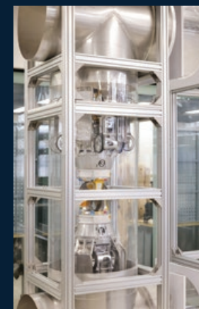
■ 在地下供水管道和網絡運作的機械人駕駛模組，負責執行檢查和維修工作
