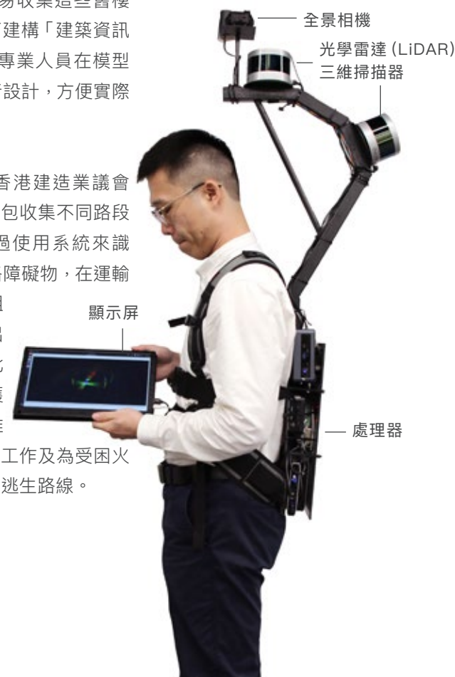
■ 三維移動測圖系統（又稱「移動測量背包」）
