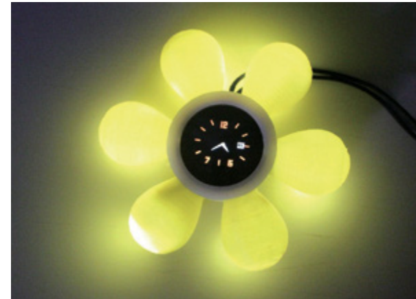
■ 此智能藥盒是曾鏡鏘和團隊的得獎發明，可提示病者按時服藥，藥物可放在其花瓣部分；藥盒更具備鬧鐘和發光功能，同時設有配備全球定位系統的求助按鈕，在緊急時可即時聯絡照顧者。
