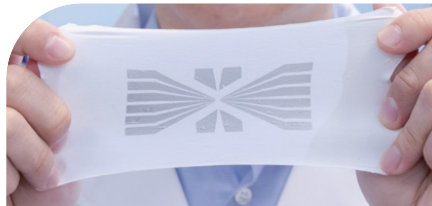
■ 以靜電紡絲方法，把液態金屬塗抹或打印於具備天然橡膠彈性的纖維氈上，使完成後的「液態金屬纖維氈」具彈性(左)，同時透氣度高(右)。
