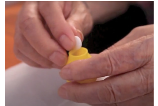
■ 此智能藥盒是曾鏡鏘和團隊的得獎發明，可提示病者按時服藥，藥物可放在其花瓣部分；藥盒更具備鬧鐘和發光功能，同時設有配備全球定位系統的求助按鈕，在緊急時可即時聯絡照顧者。
