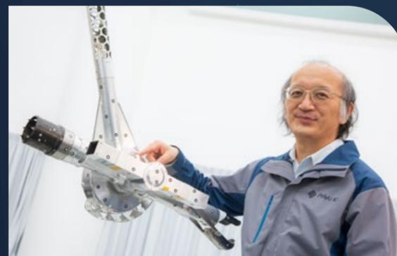
「表取採樣執行裝置」能抵受攝氏 200 度的高溫，整套裝置包含兩個採樣器，分別用於收集鬆散和黏性的月球樣本；兩部內置的耐熱近攝相機，可在樣本採集過程中發揮監察和視像導航功能；以及一套初級封裝系統，可將樣本密封並保存於容器之中。
