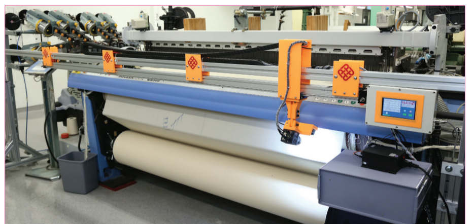
安裝於織布機上的「聰明眼」 "WiseEye" integrated on a weaving machine
