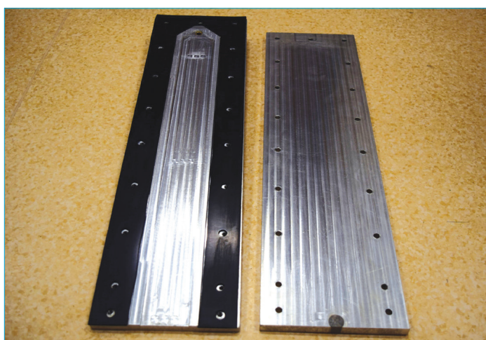
大氣酸性超細粒子擴散採樣器 Diffusion sampler for acidic ultrafine particles in the atmosphere
