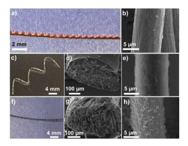
可穿戴電子技術日漸受關注, 估計其市場份額將在 2025年達到800億美元。有見及此, 理大團隊成功 研究出具有全方位柔性和穩定電化學性能的柔性線 狀鋰金屬電池。電池可彎曲至半徑少於1mm,並在 0.2C電流密度下充放電多於400次。此技術可提供 高性能儲能表現, 可應用於柔性電子器件集成系統 以及智慧服飾。
