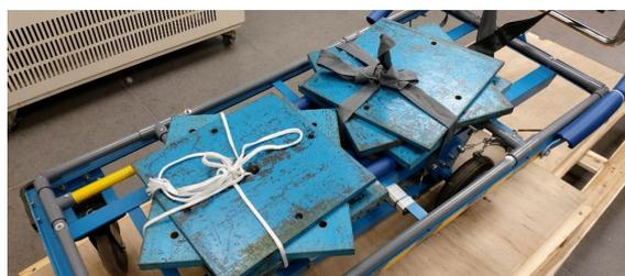
圖4：斜台上分散擺放重100KG的鐵片，模擬紙皮的重量。
