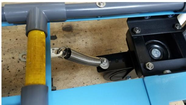
圖3：加上彈簧這個裝置，防止萬向輪旋轉速度太快，此為新設計的「半萬向輪」裝置。
