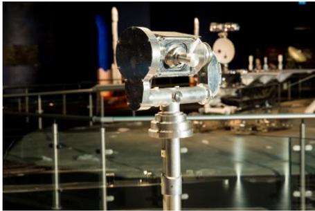
「相機指向系統」安裝於月球著陸器頂端，有助在月球上拍攝全景圖像，及觀察探測器移動，協助為安全移動建立月球地型的精確 3D 模型。該系統設計複雜，僅重 2.8 公斤，但十分堅固，足夠保護鏡頭不受衝擊及震動影響，確保其可以在極端的月球環境下正常運作。
