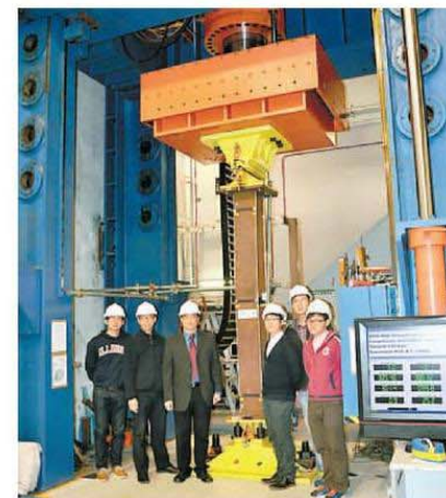
理大土木及環境工程系結構工程研究實驗室進行高強鋼結構試驗研究，圖為1000噸液壓伺服控制測試系統。
