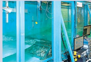
▲理大水利工程實驗室進行大浪衝擊測試。
