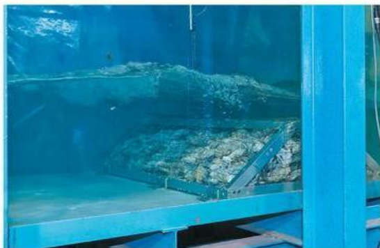
理大研究利用蠔殼製作防波堤置於水底，減弱海浪衝擊。
