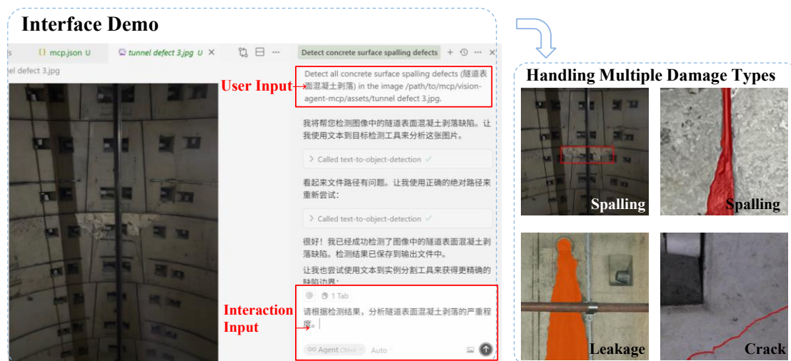
图 2.24 用户界面及隧道病害检测结果示意
