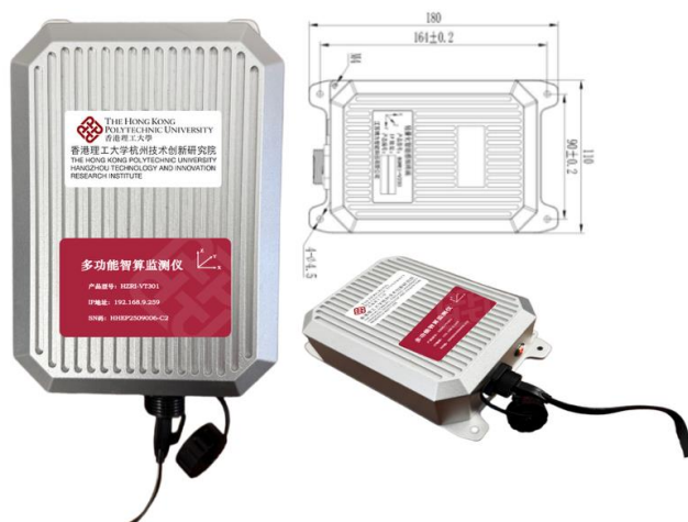
图 2.93 高可靠性多功能集成式一体化传感器
