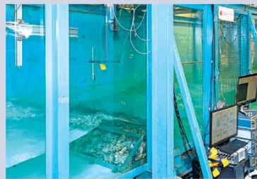
▲理大水利工程實驗室進行大浪衝擊測試。
