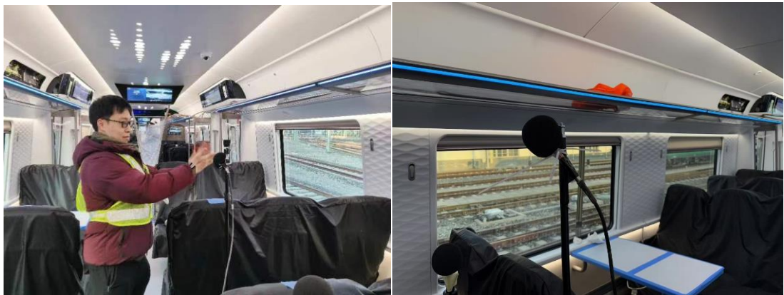
图 2.97 车内麦克风传感器测点布置
