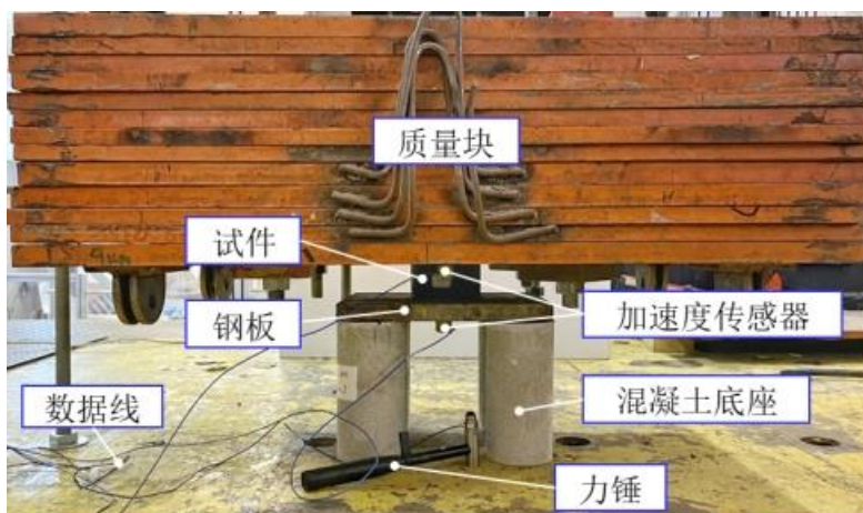
图 2.118 弹性橡胶支座冲击试验示意图
