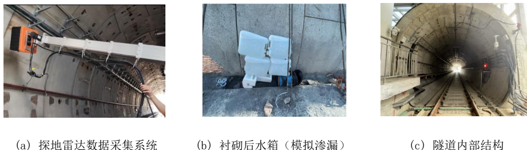
图 2.26 现场试验设计及数据采集系统示意图
