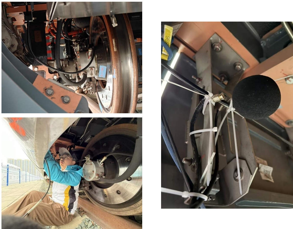
图 2.96 轮轨近场麦克风传感器测点布置
