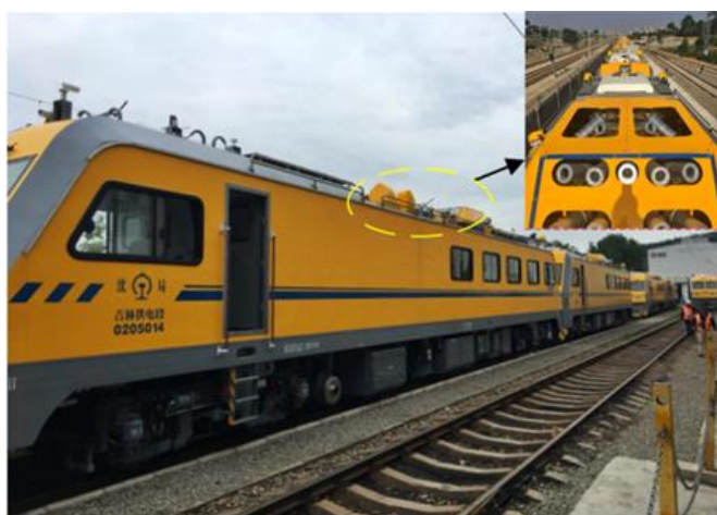
图 2.47 接触网检测车图像采集系统
