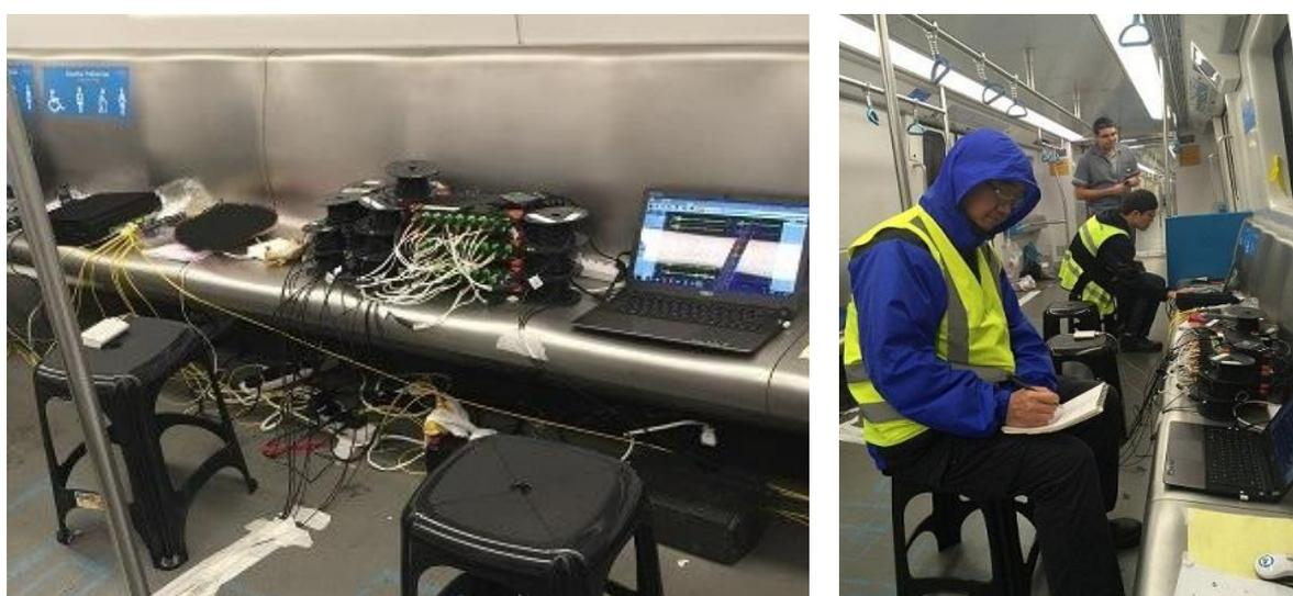
图 5-15 列车在线监测系统实时采集、分析巴西地铁列车运行状态数据
