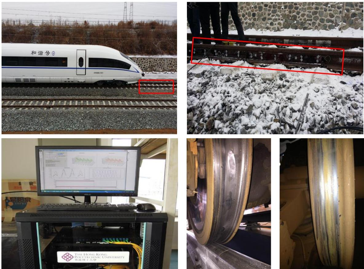
图 5-4 对高速列车的车轮扁疤和多边形化故障进行实时监测和识别
