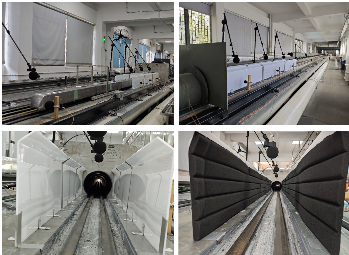
图 2.8 中南大学地铁列车线路声屏障动模型测试
