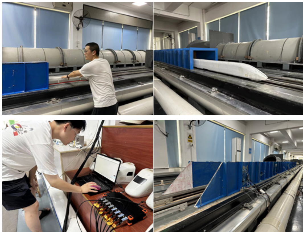
图 2.7 中南大学高速列车 - 声屏障气动效应测试
