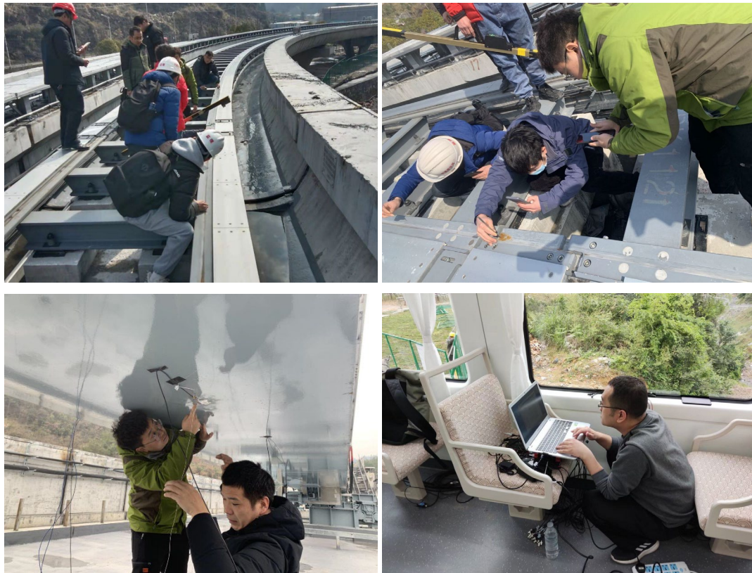
图 2.20 凤凰磁浮现场传感器安装与监测
