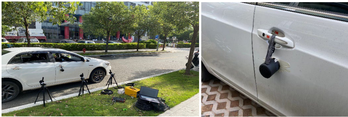
图 2.14 道路旁模拟列车轮对轴承伤损轨旁测试及扬声器固定
