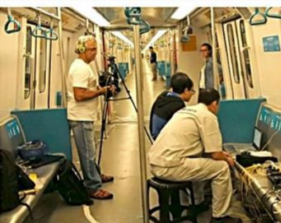
理大團隊利用自主研發的光纖傳感器技術，針對地鐵列車上的結構部件動力性能進行監測。
