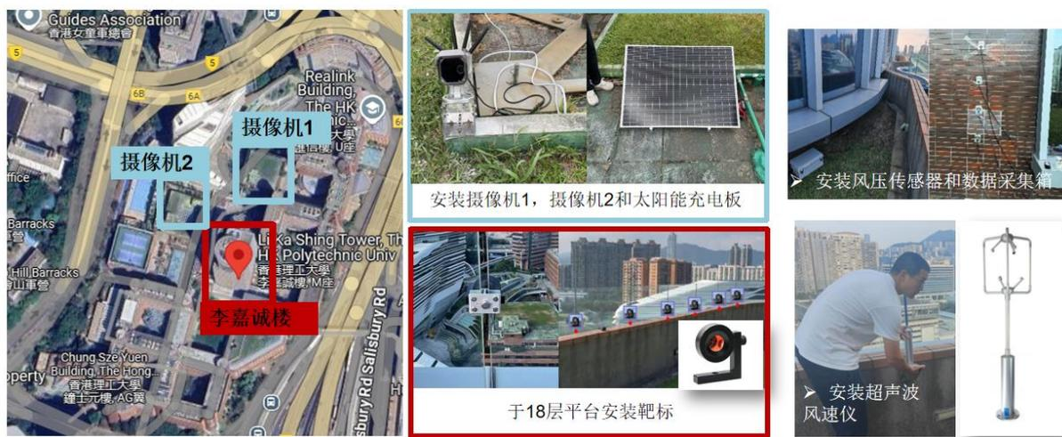
图 2.40 香港理工大学李嘉诚楼台风监测系统设备及现场安装示意图
