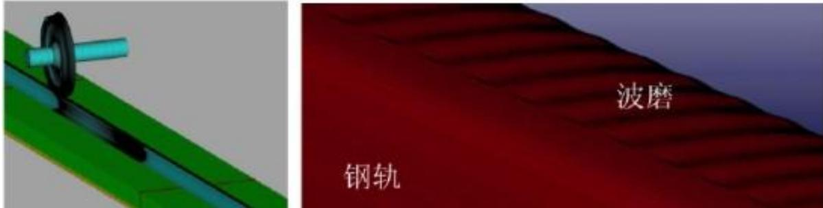
图 2.18 三维轮轨瞬态滚动接触模型
