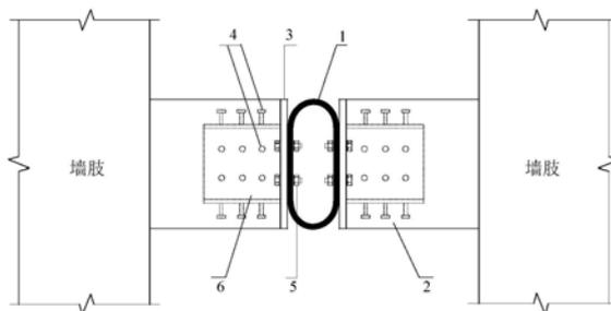
1. 一种基于超弹性形状记忆合金的自复位连梁的承载力的计算方法,所述自复位连梁安装在两墙肢之间,其特征在于,包括两钢筋混凝土连梁段(2),以及连接该两钢筋混凝土连梁段(2)的自复位连梁段(1);自复位连梁段(1)呈O形状;两钢筋混凝土连梁段(2)分别浇筑或预制装配在所述两墙肢上;自复位连梁段(1)由超弹性形状记忆合金制成;钢筋混凝土连梁段(2)的屈服承载力要大于自复位连梁段(1)的屈服承载力;钢筋混凝土连梁段(2)内预埋有工字形型钢(6),自复位连梁段(1)通过高强螺栓(5)与工字形型钢(6)固定连接;自复位连梁段(1)和工字形型钢(6)之间垫设有端板(3);
