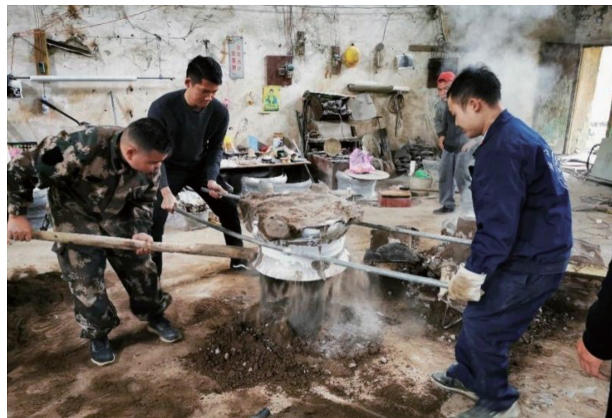
圖三 環江砂模法鑄造銅鼓 鄒桂森拍攝
